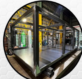
角パイプ 架台
